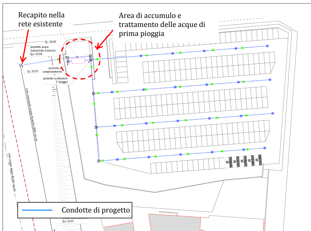
Figura 2.3 – Schema planimetrico rete di drenaggio lotto B.
